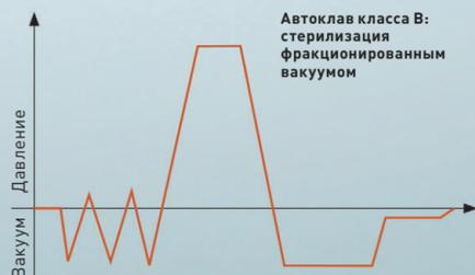
Автоклав класса В: стерилизация фракционированным вакуумом
