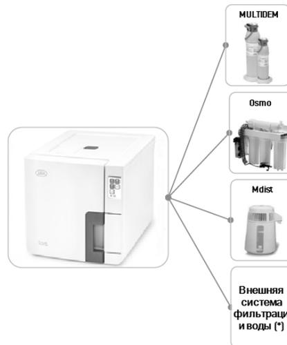
**Учтите (\*):** Система фильтрации воды должна быть оснащена устройством предотвращения противоток в соответствии с требованиями стандарта IEC 61770, местными и национальными требованиями.
