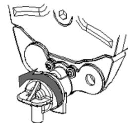
**4** Снимите крышку фильтра и вытащите картридж фильтра.
