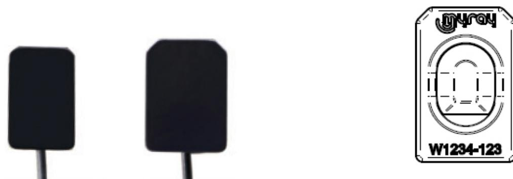
Auf der Rückseite des Sensors sind das Warenzeichen (Logo) des Herstellers, die Kennnummer des Produkts und die Seriennummer des Einzelteils angebracht.
