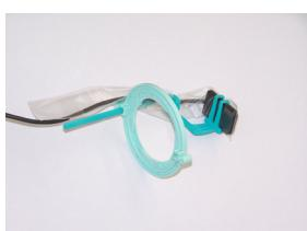
El uso de un dispositivo de colocación garantiza el centrado del área sensible del sensor y su perpendicularidad respecto al tubo de rayos x. El uso del dispositivo de colocación está altamente recomendado, la elección del modelo más adecuado se deja a la experiencia del odontólogo.
