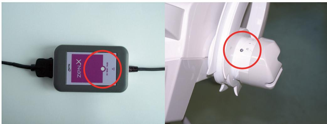
Un témoin de couleur rouge indique une situation d'anomalie grave pour laquelle il est impossible de prendre de radio (l'autodiagnostic au démarrage a détecté un problème).
