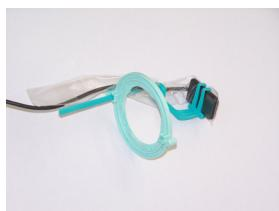
L'utilisation d'un positionneur garantit le centrage de la zone sensible du capteur et sa perpendicularité par rapport au tube radiogène. L'utilisation du positionneur est fortement recommandée, le choix du modèle le plus adapté est laissé au chirurgien-dentiste en fonction de son expérience.
