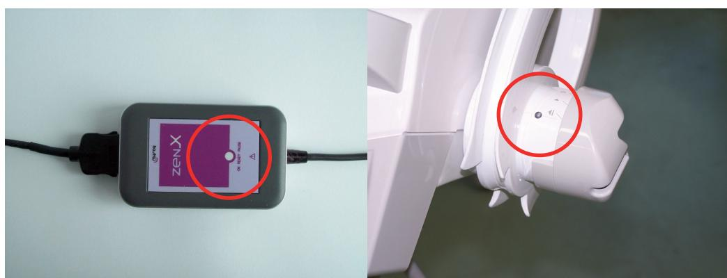
红色指示灯代表系统有个严重的错误且无法继续拍摄X射线照片（开机时自我诊断系统会侦测到相关信息）。
