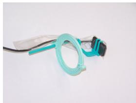
使用一个定位器保证传感器的敏感区域在中心位置，并且与X射线管保持垂直状态。所以强烈推荐使用定位器。临床医生应该根据经验选择一个最适合他/她的。
