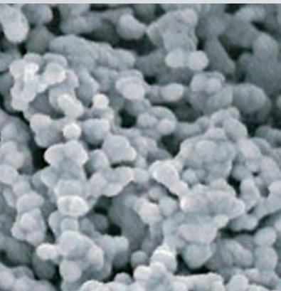
AgProtect™: типичная структура металлического порошка, полученного при конденсации с помощью инертного газа (nano powder technology). Это антимикробное покрытие из наносеребра (Ag) уменьшает количество патогенной флоры на микроскопе и снижает вероятность перекрестного инфицирования.
